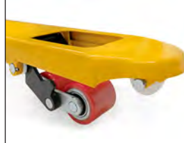
Tandem-Rollen 2 Rollen in jeder Gabel wippend gelagert. Vorteilhaft bei unebenen Böden und Überfahren von Kanten und Schwellen. Kletterrollen an den Gabelspitzen.
