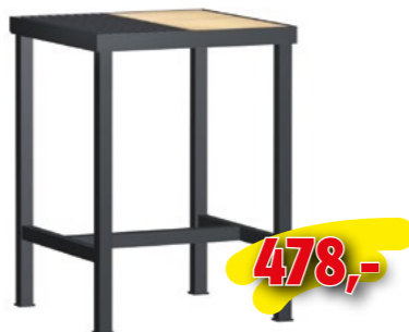
Schweißstisch WPS01N-0625-001 625 x 625 x 855 mm L x T x H, geteilte Arbeitsfläche mit Schamottsteinen und Rost. Rosthöhe: 50 mm
